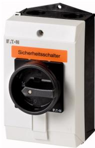
**Sicherheitsschalter 3p+1S+1Ö, 25 A, NOT-HALT-Funktion, abschließbar in 0-Stellung mit Deckelverriegelung, Aufbau, mit Warnschild 'Sicherheitsschalter'**
